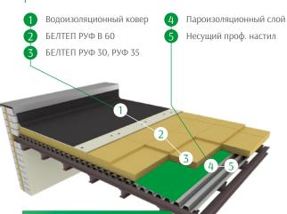
Нижний слой двухслойной теплоизоляции совмещенных кровель.
