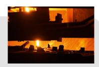
Процесс производства плит БЕЛТЕП начинается с подачи материалов в вагранку, где происходит процесс плавления и получение силикатного расплава.
