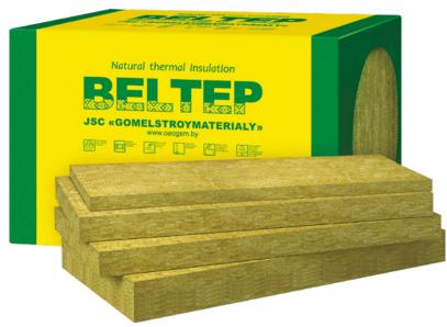
Минеральная вата для плит теплоизоляционных БЕЛТЕП производится на основе базальтового волокна. Ее теплоизоляционные свойства обусловлены хаотичным расположением волокон и содержанием между ними большого количества воздушных пор, которые отличаются низкой теплопроводностью. В процессе изготовления ковер прессуется, проходит через тепловую обработку, отверждается, режется на изделия и упаковывается.
