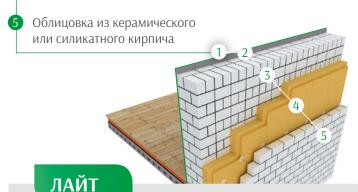
Теплоизоляционный слой в конструкциях трехслойных стен, частично или полностью выполненных из мелкоштучных стеновых материалов. Первый (внутренний) слой в вентилируемых системах утепления фасадов и кровель при устройстве двухслойной изоляции. Тепло-, звукоизоляционный слой в конструкциях перегородок, полов на лагах, потолков, надподвальных перекрытий с решетчатым каркасом.
