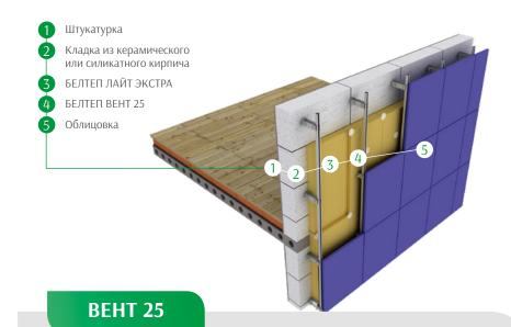
Теплоизоляционный слой в навесных фасадных системах с воздушным зазором при однослойном исполнении изоляции.
