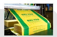
Плиты минераловатные БЕЛТЕП упаковываются в пленку, укладываются на поддоны (паллеты) и дополнительно обтягиваются стрейчхуд пленкой, что позволяет обеспечить механизированную погрузку и выгрузку продукции и хранение на открытых площадках.
