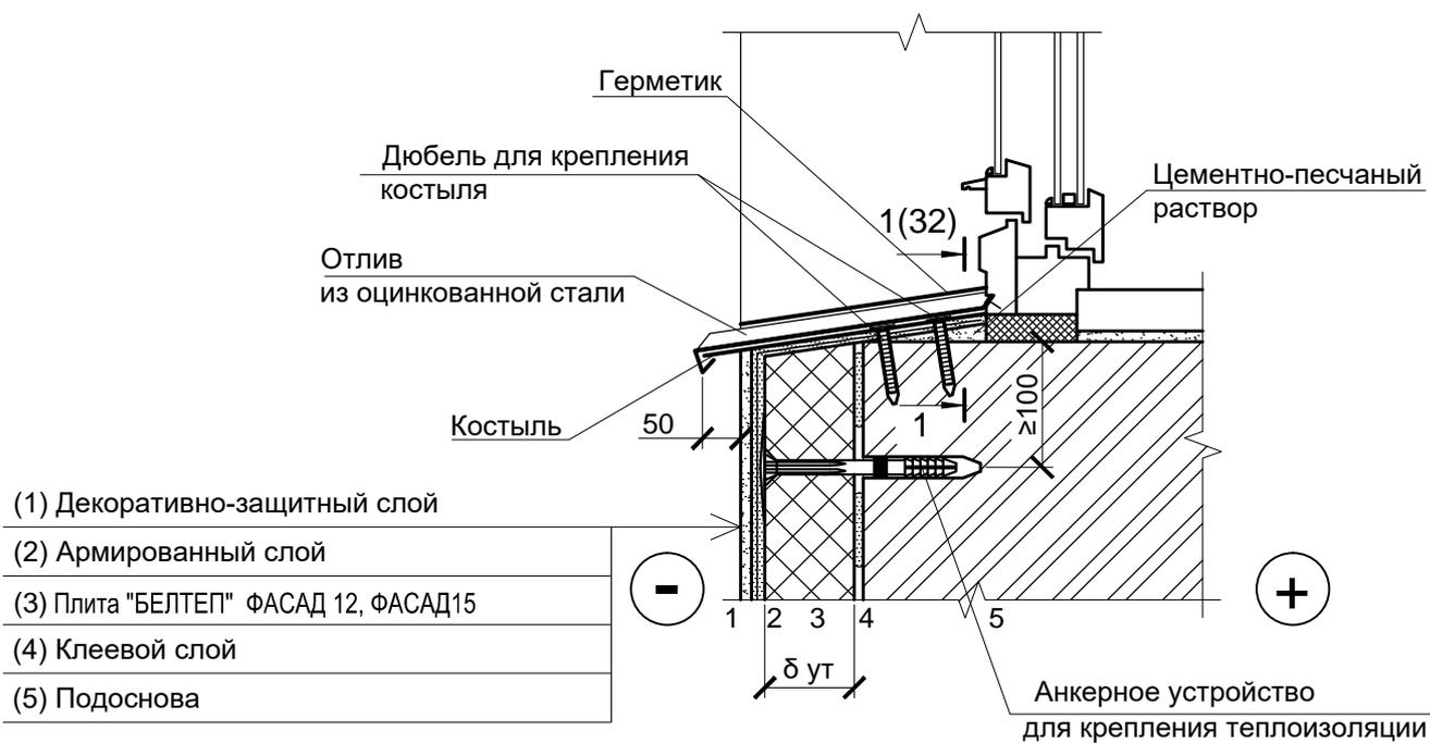
1 Толщина теплоизоляционного слоя принимается по расчету.
