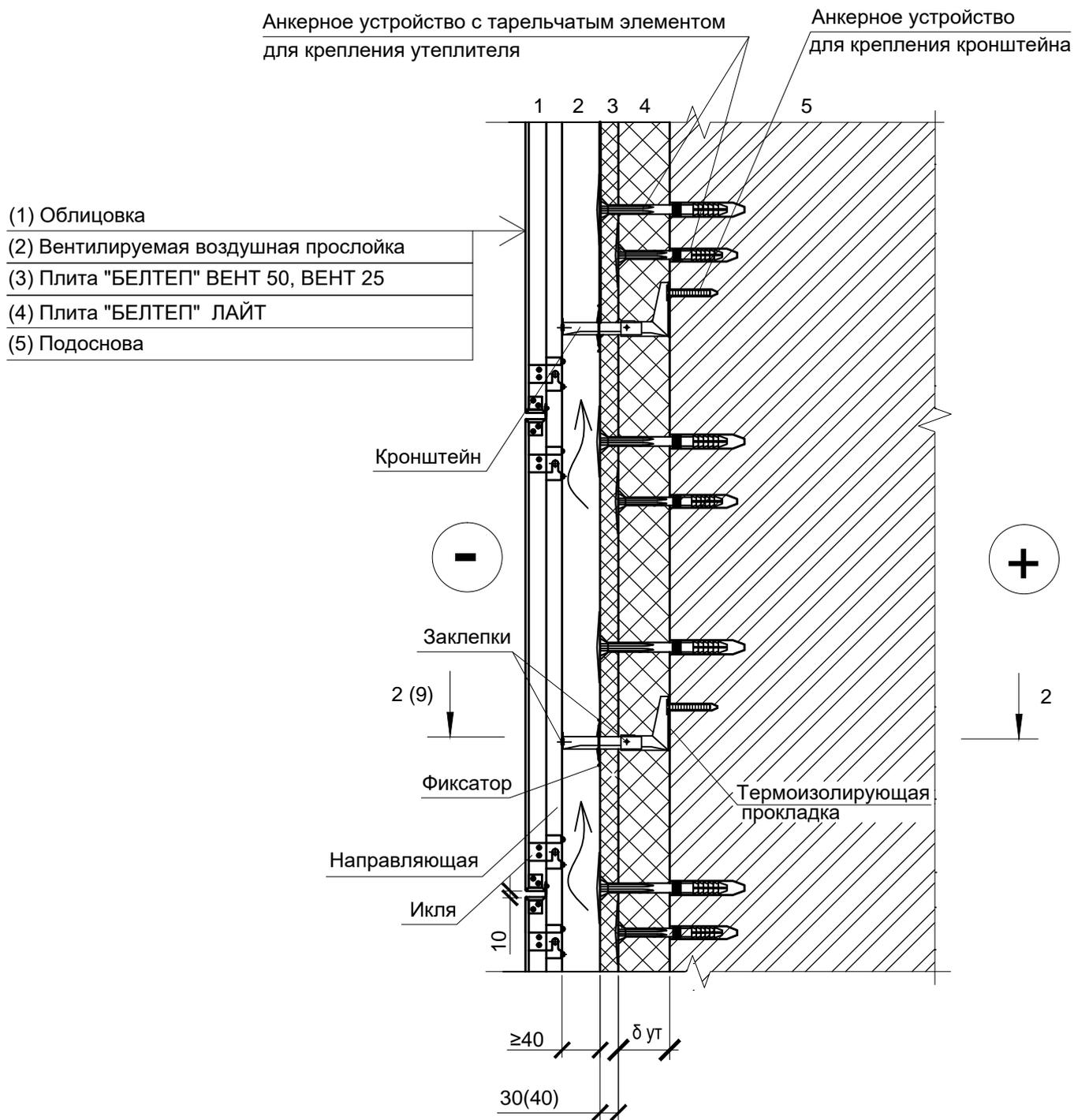
1 Толщина теплоизоляционного слоя принимается по расчету .
