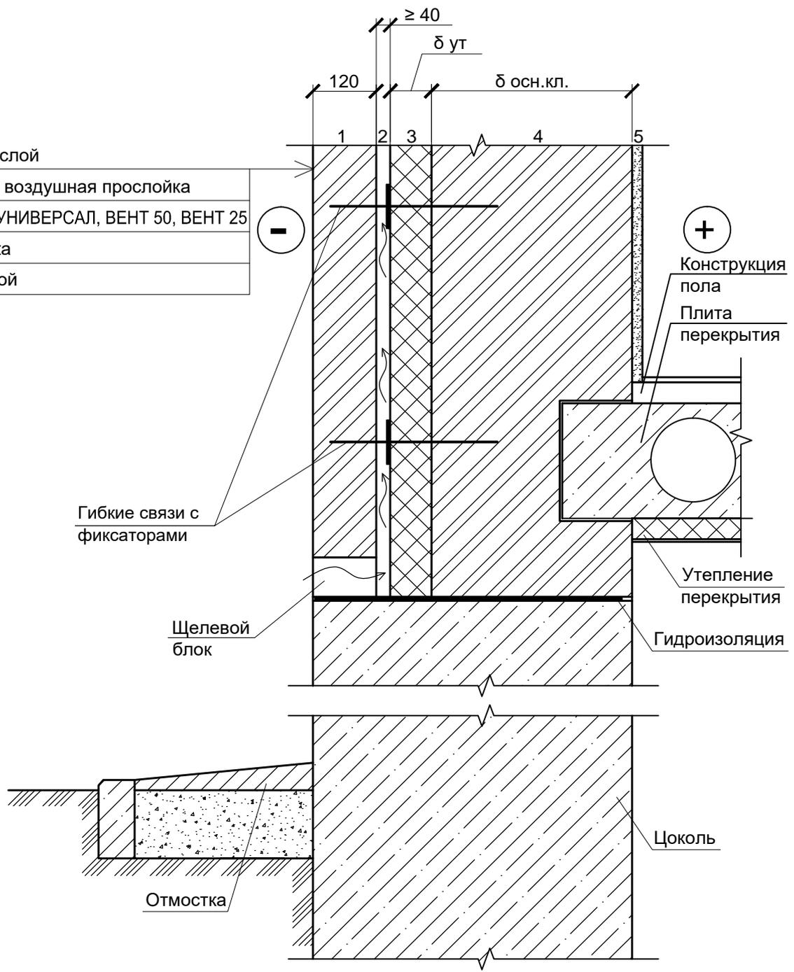
1 Толщина основной кладки принимается в соответствии с конструктивным решением здания.
