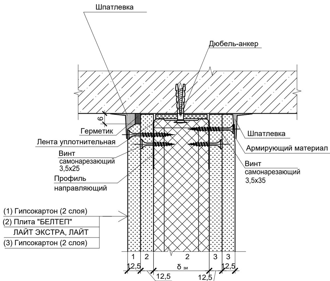
1 Толщина звукоизоляционного слоя принимается по расчету.
