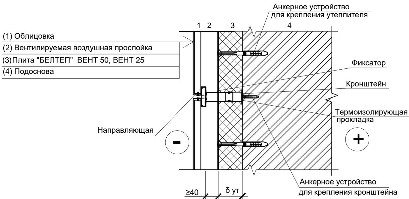
1 Толщина теплоизоляционного слоя принимается по расчету .
