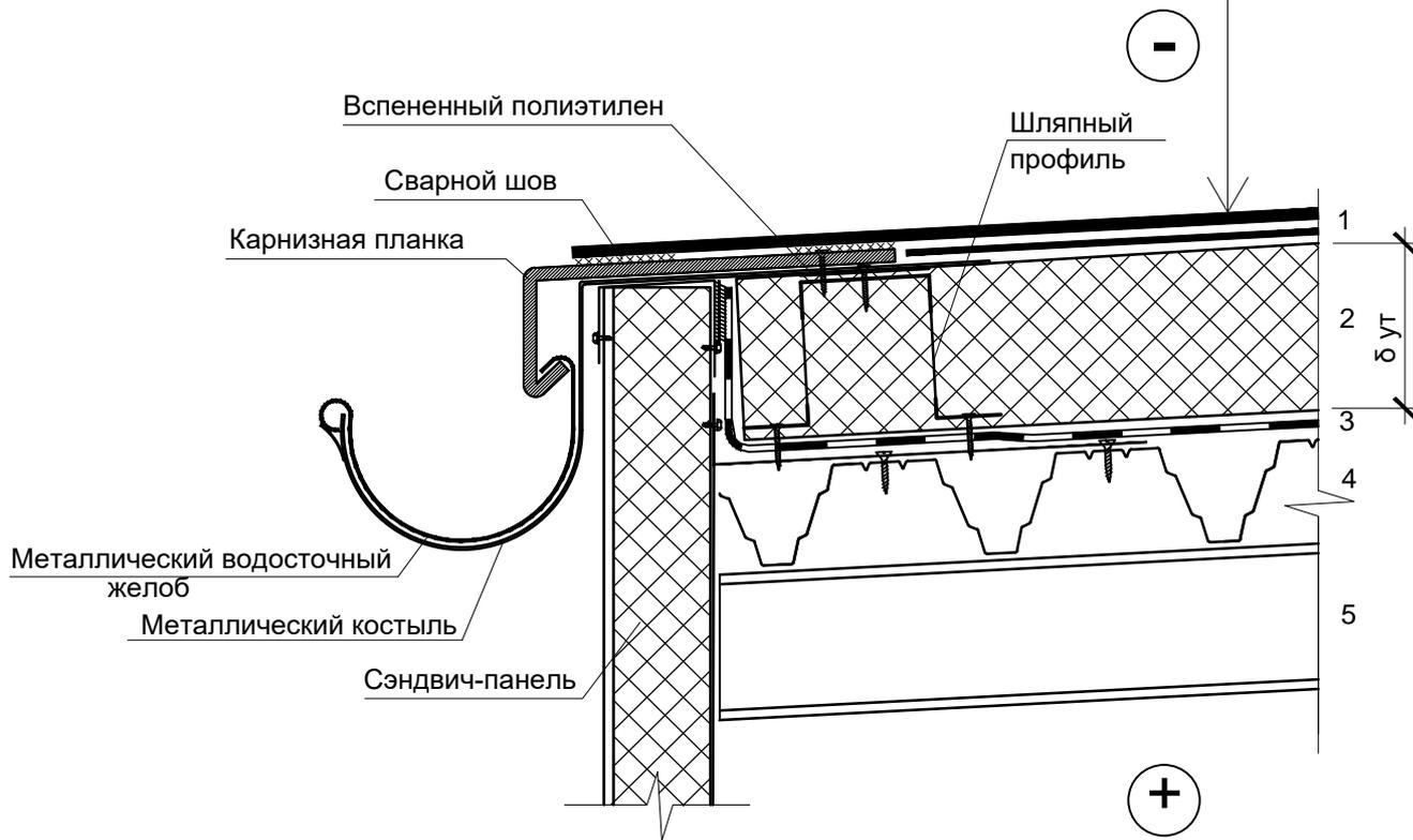
1 Толщина теплоизоляционного слоя принимается по расчету.
