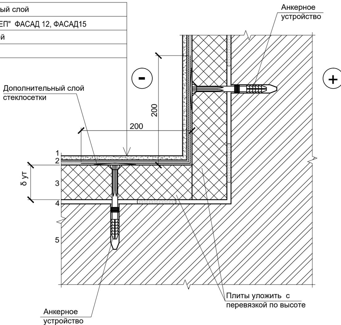
1 Толщина теплоизоляционного слоя принимается по расчету .
