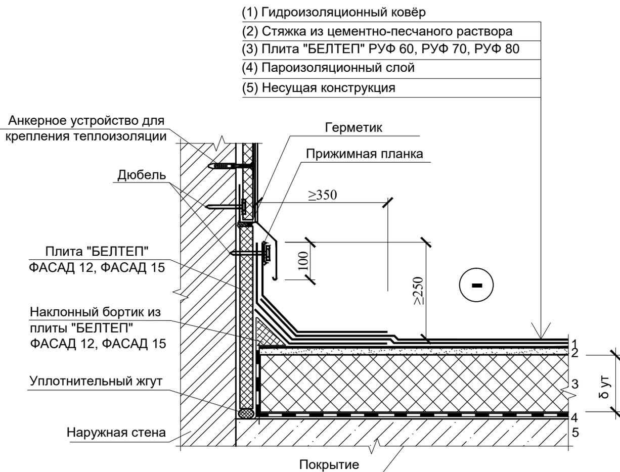
1 Толщина теплоизоляционного слоя принимается по расчету.
