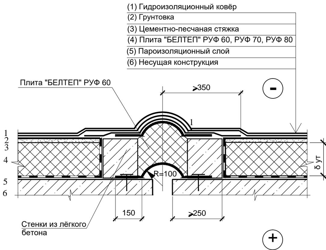
1 Толщина теплоизоляционного слоя принимается по расчету.
