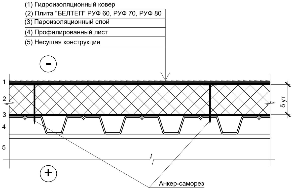
1 Толщина теплоизоляционного слоя принимается по расчету.
