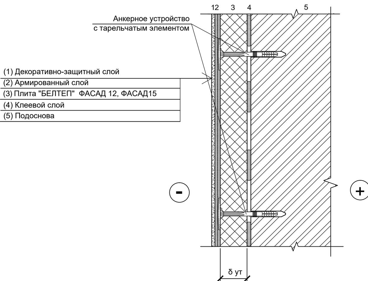
1 Толщина теплоизоляционного слоя принимается по расчету.
