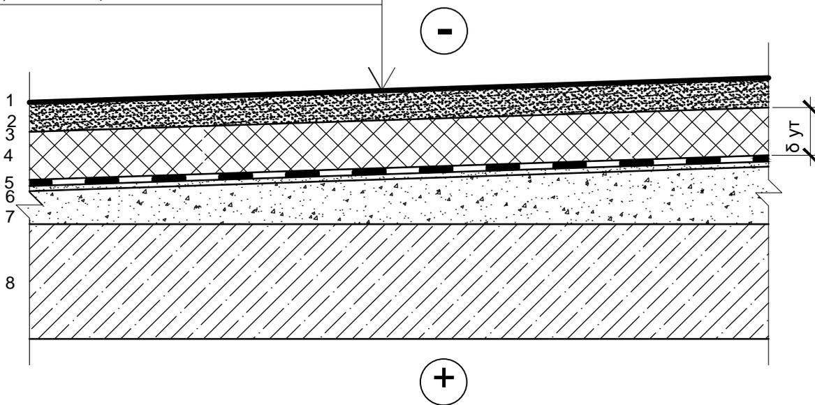
1 Толщина теплоизоляционного слоя принимается по расчёту.
