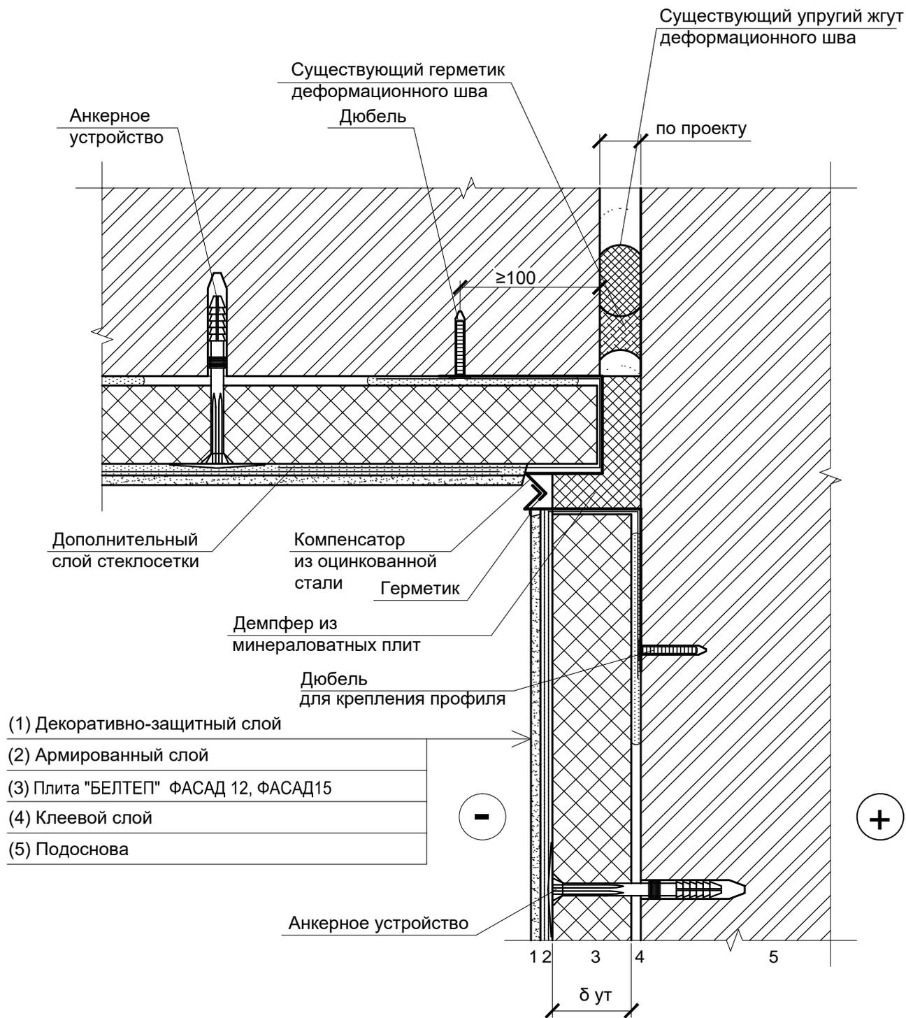
1 Толщина теплоизоляционного слоя принимается по расчету .
