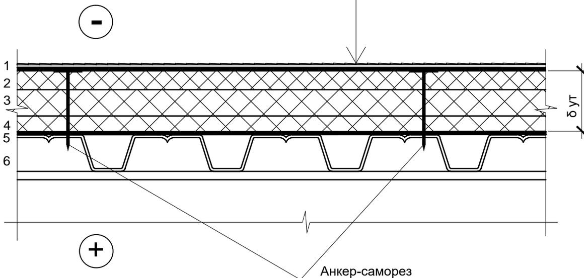
1 Толщина теплоизоляционного слоя принимается по расчету.
