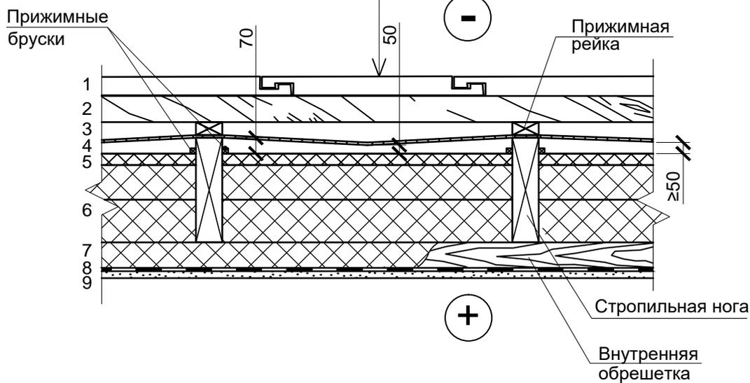
1 Толщина теплоизоляционного слоя принимается по расчету.
