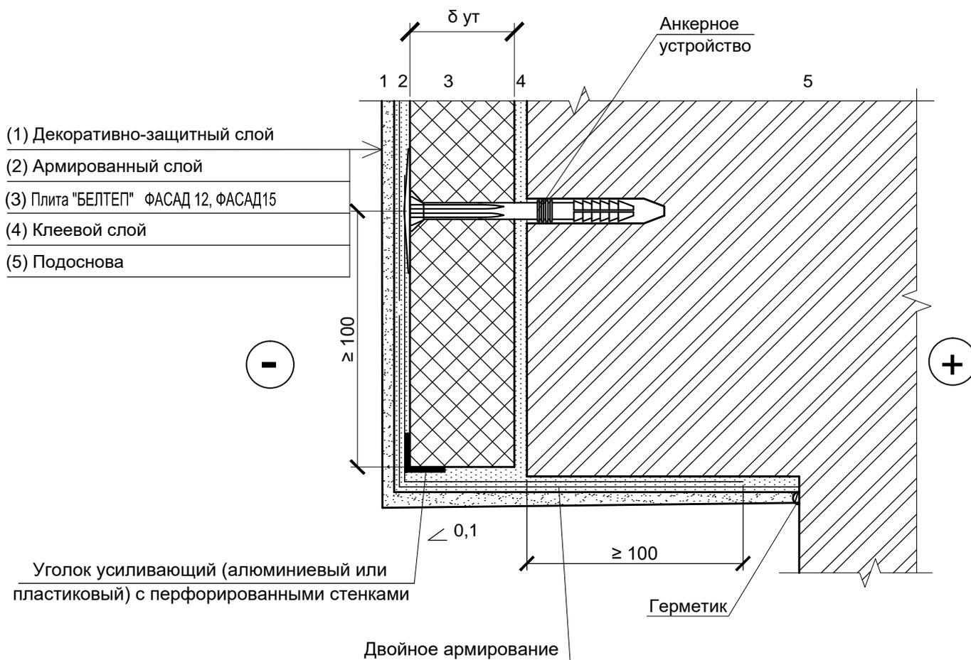
1 Толщина теплоизоляционного слоя принимается по расчету .
