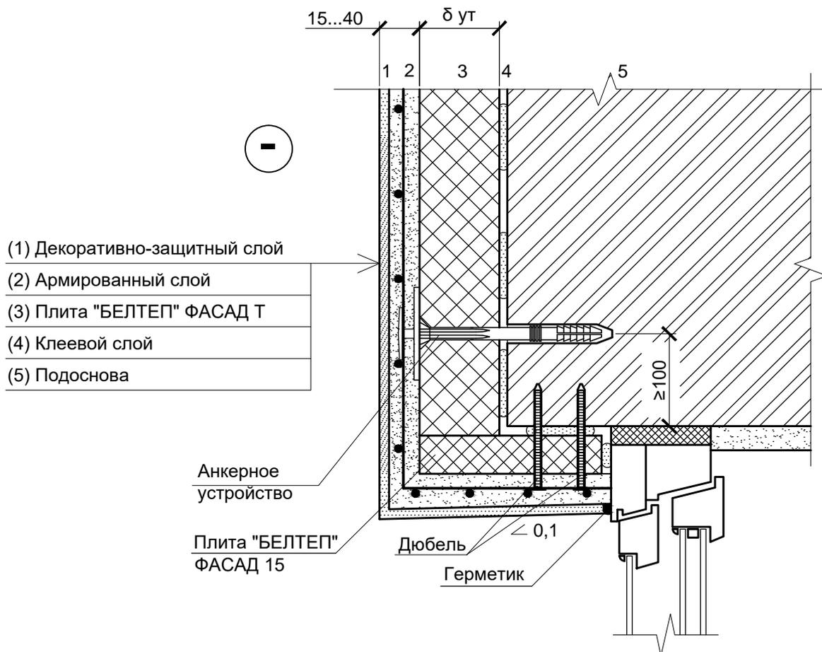
1 Толщина теплоизоляционного слоя принимается по расчету .
