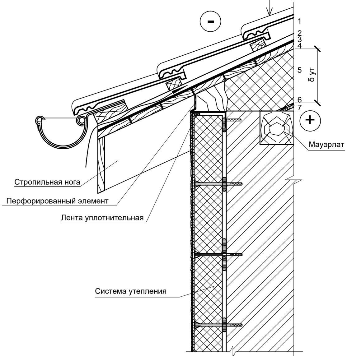
1 Толщина теплоизоляционного слоя принимается по расчету.
