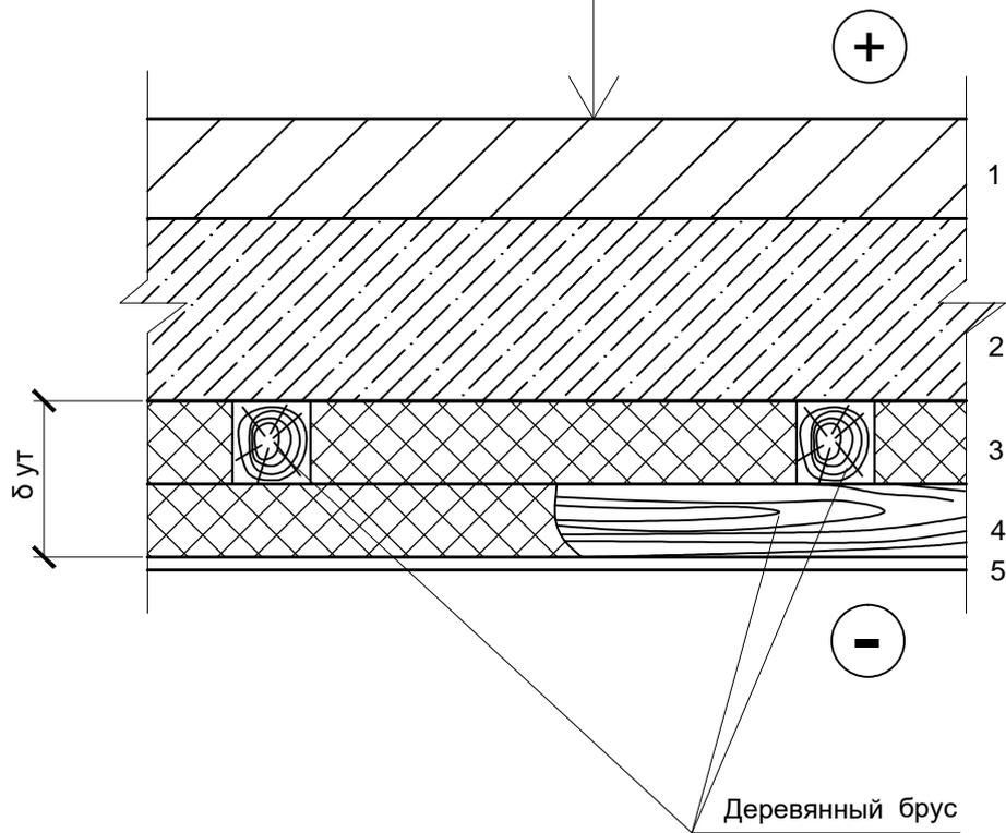
1 Толщина теплоизоляционного слоя принимается по расчету.
