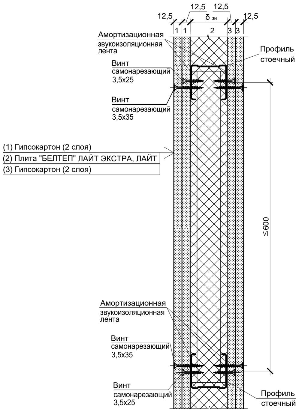
1 Толщина звукоизоляционного слоя принимается по расчету.
