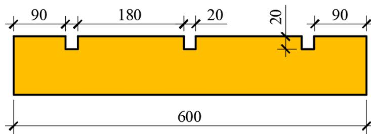
Рисунок 1 – Плита теплоизоляционная «БЕЛТЕП» с канавками
