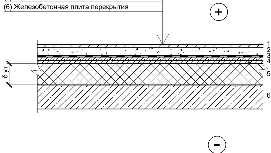
1 Толщина теплоизоляционного слоя принимается по расчету.
