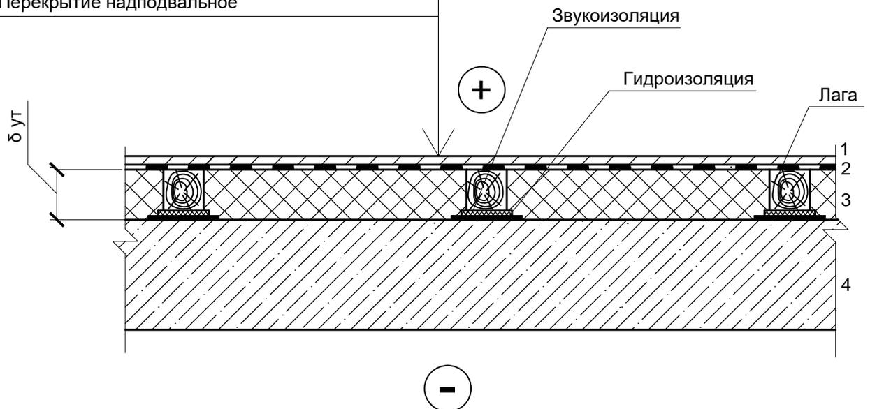
1 Толщина теплоизоляционного слоя принимается по расчету.
