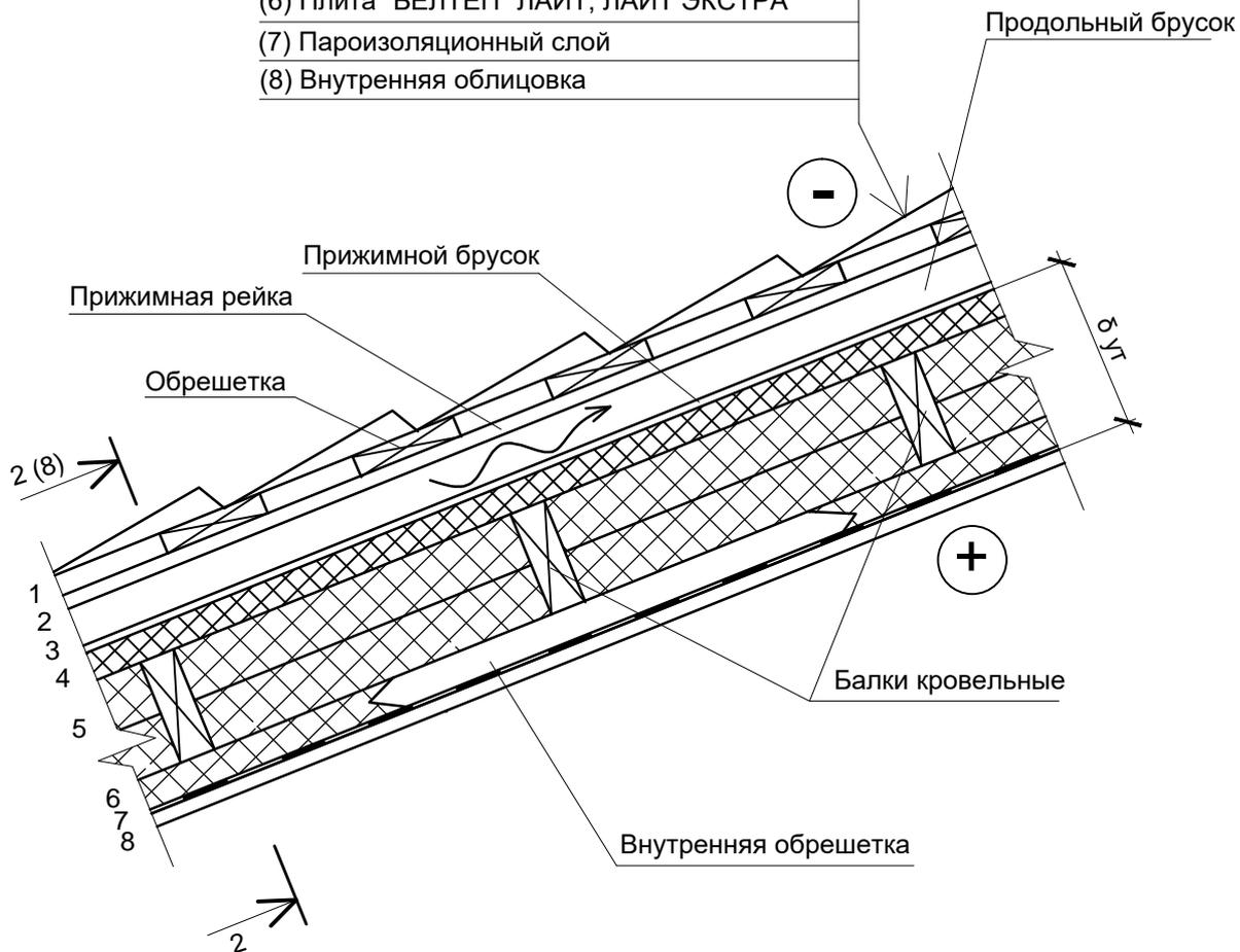
1 Толщина теплоизоляционного слоя принимается по расчету.
