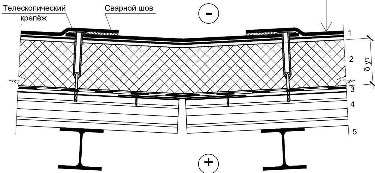
1 Толщина теплоизоляционного слоя принимается по расчету.
