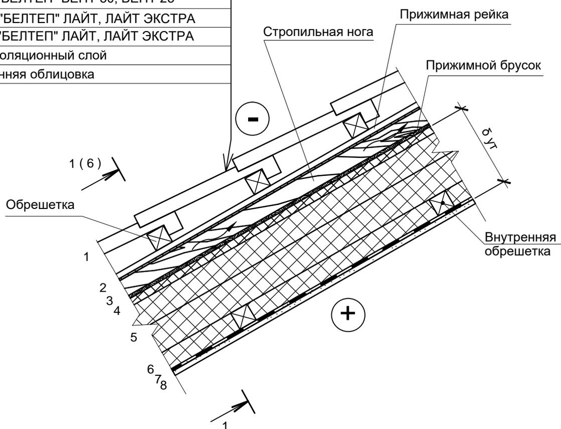
1 Толщина теплоизоляционного слоя принимается по расчету.
