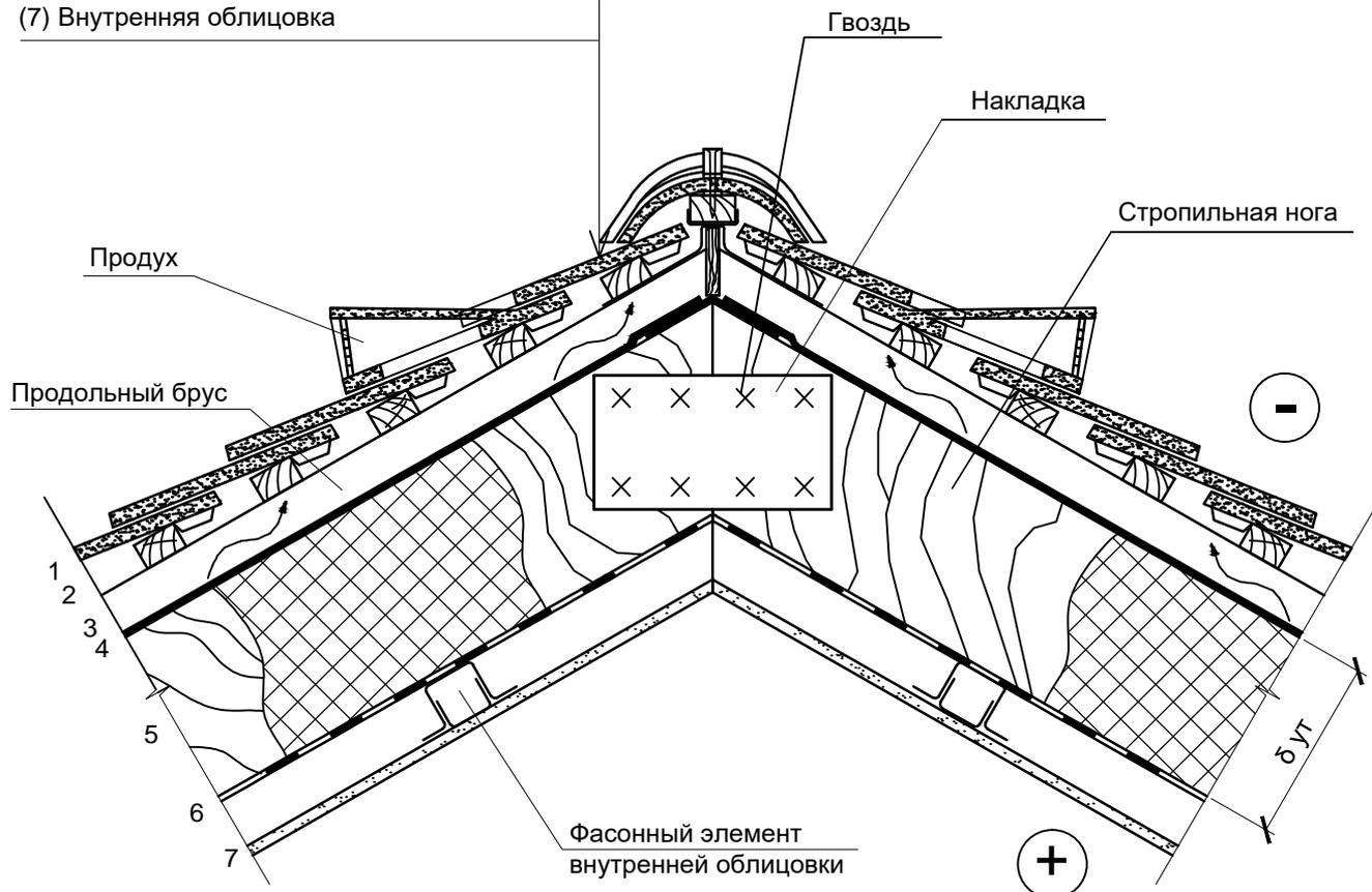
1 Толщина теплоизоляционного слоя принимается по расчету.
