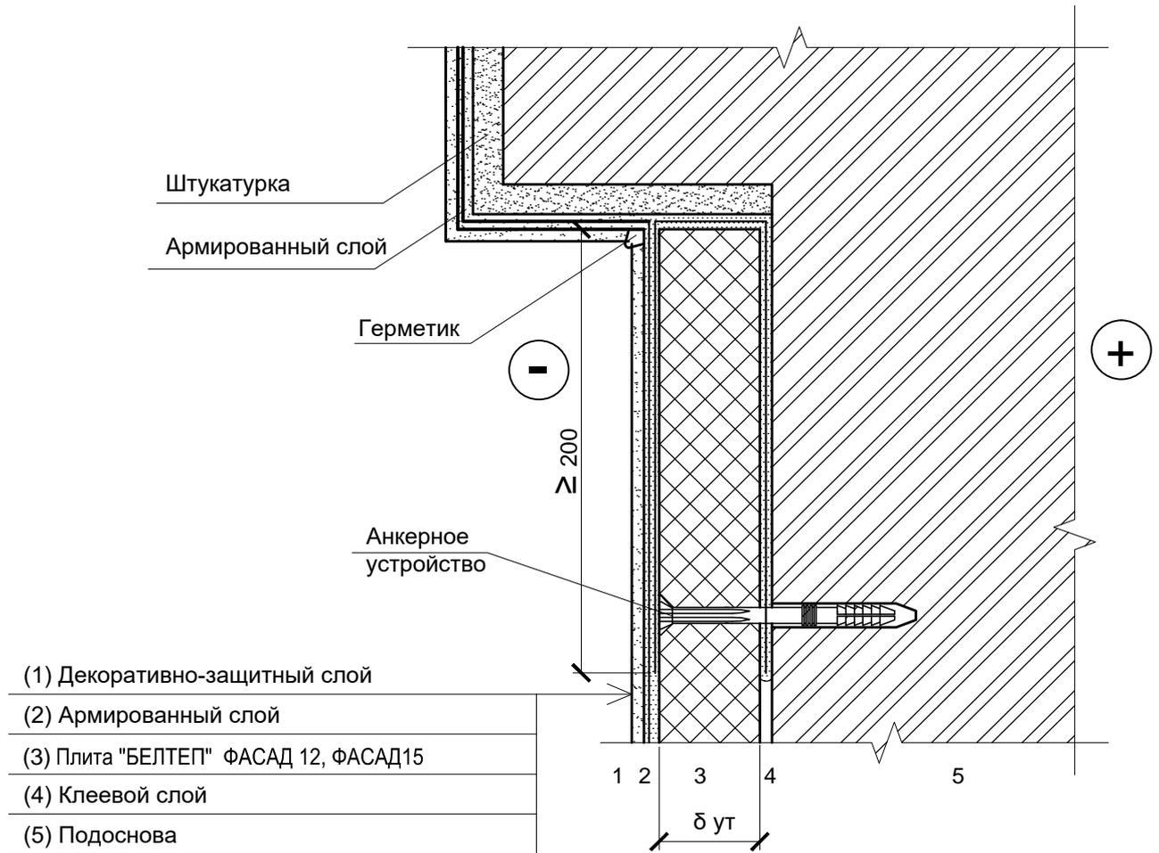
1 Толщина теплоизоляционного слоя принимается по расчету .
