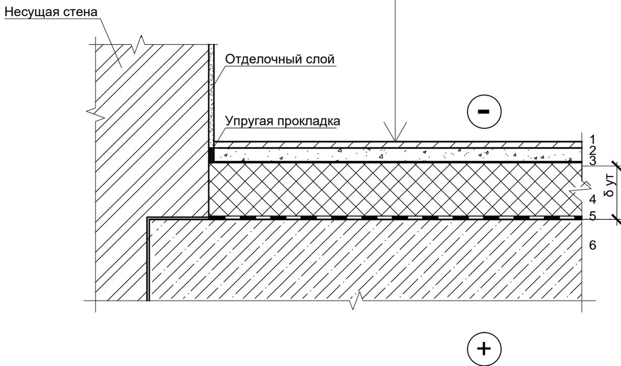
1 Толщина теплоизоляционного слоя принимается по расчету.
