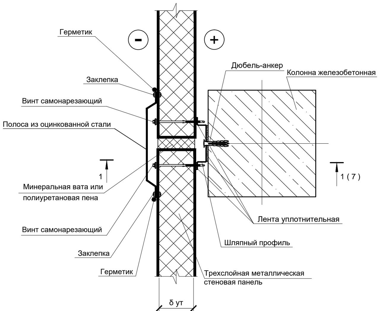
1 Толщина теплоизоляционного слоя принимается по расчету .
