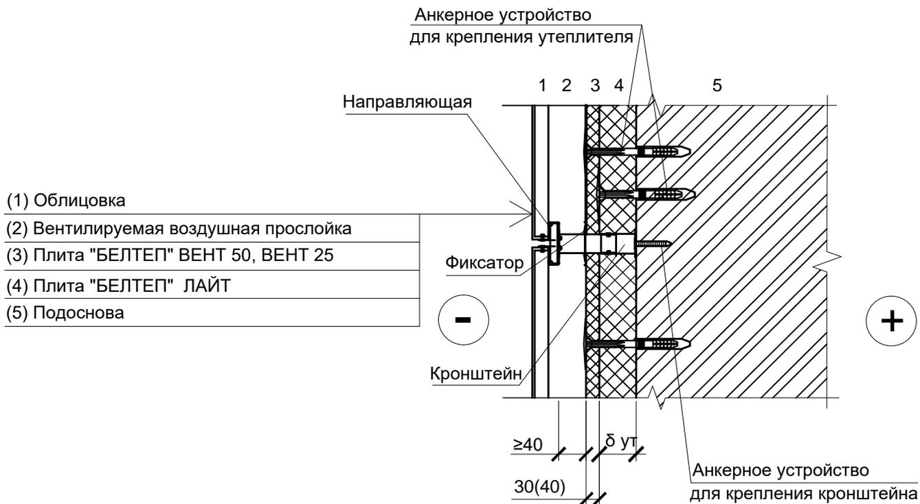
1 Толщина теплоизоляционного слоя принимается по расчету .
