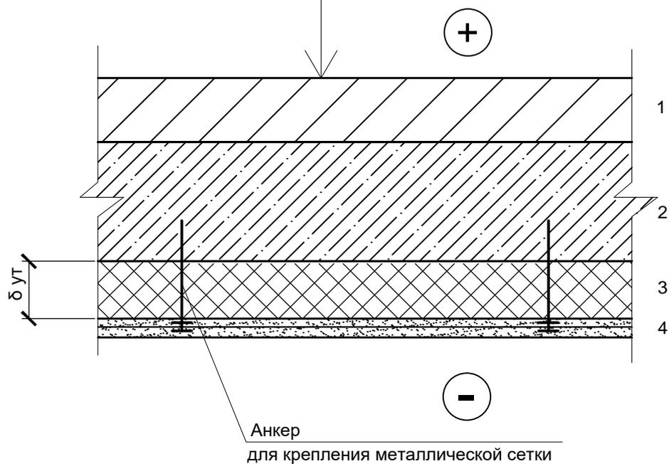
1 Толщина теплоизоляционного слоя принимается по расчету.
