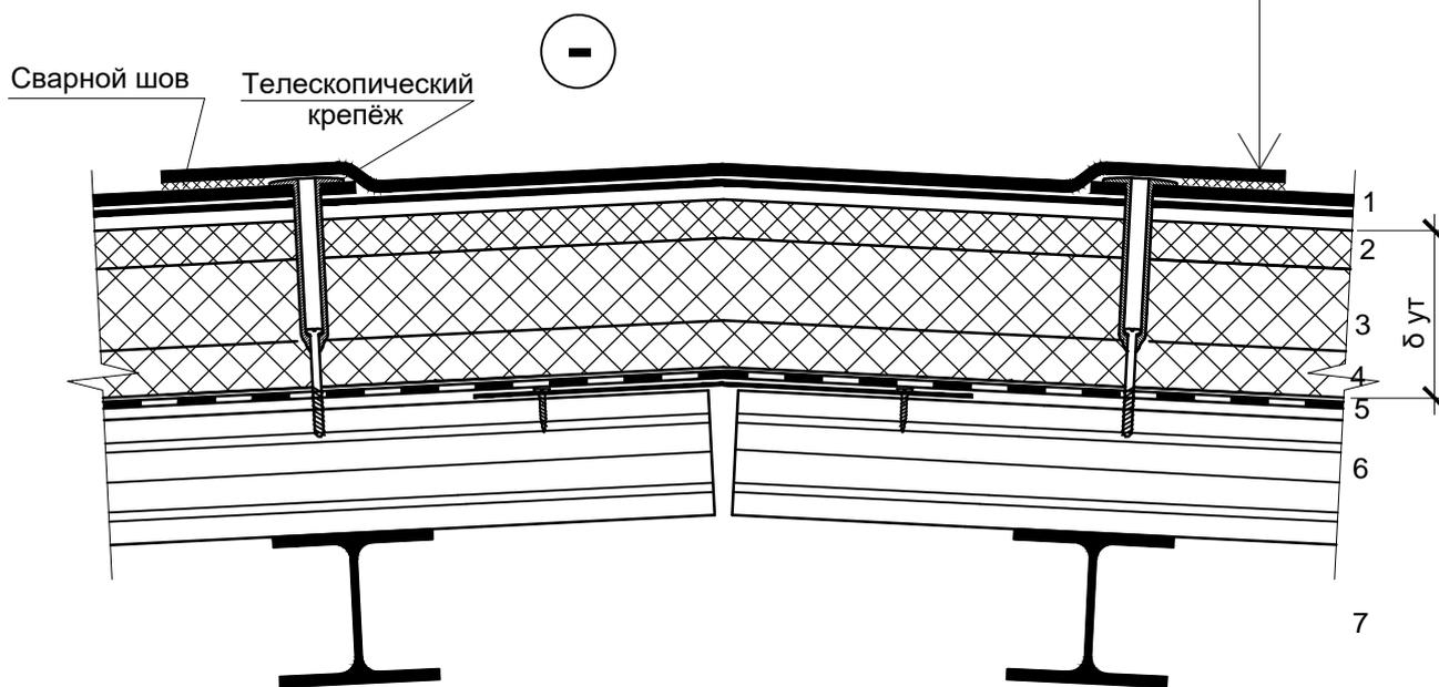
1 Толщина теплоизоляционного слоя принимается по расчету.
