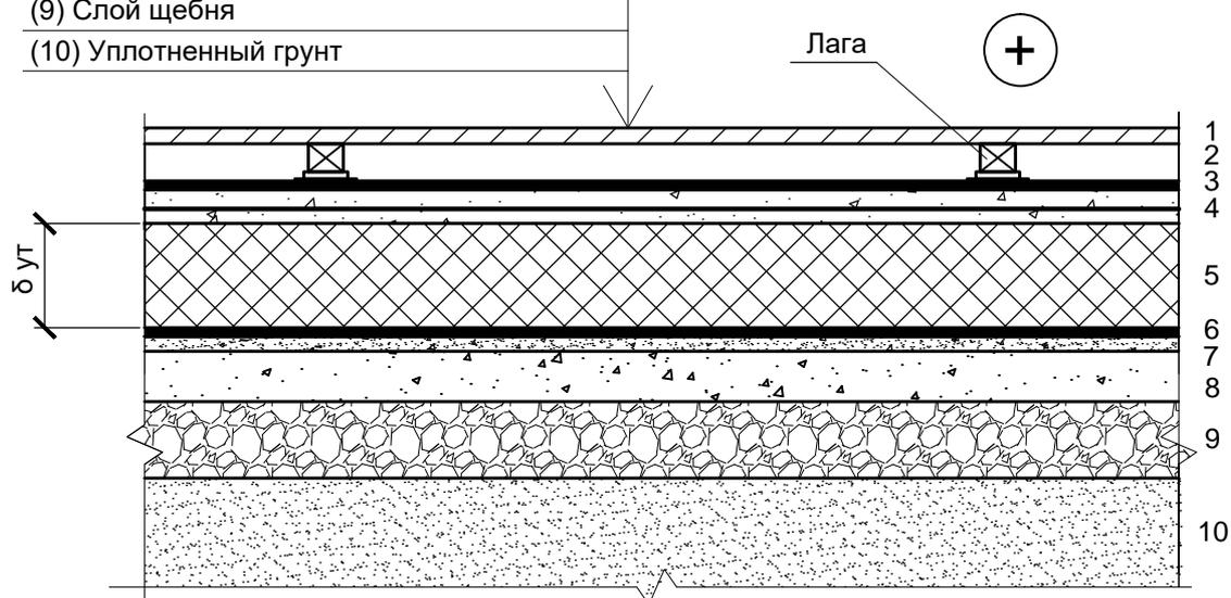
1 Толщина теплоизоляционного слоя принимается по расчету.
