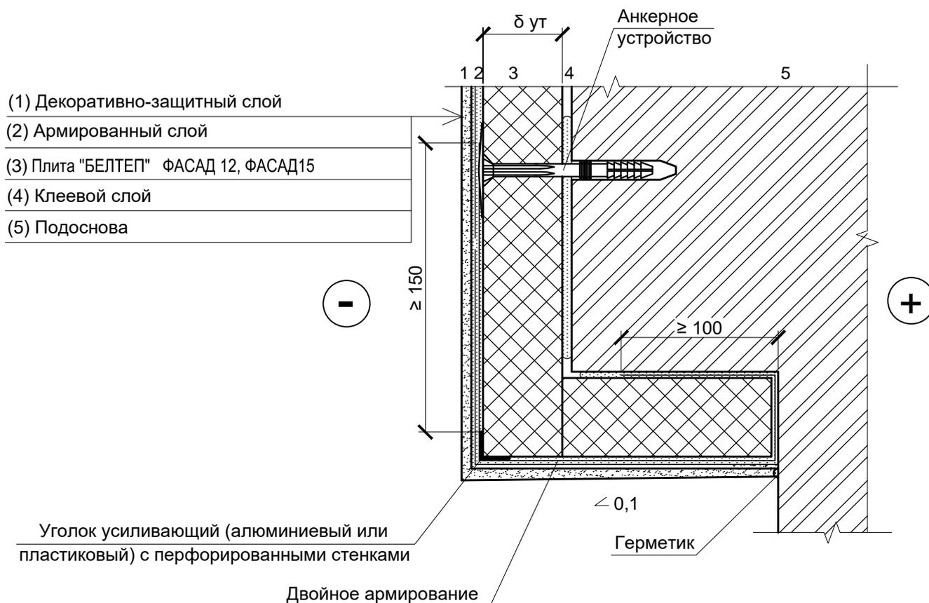
1 Толщина теплоизоляционного слоя принимается по расчету .
