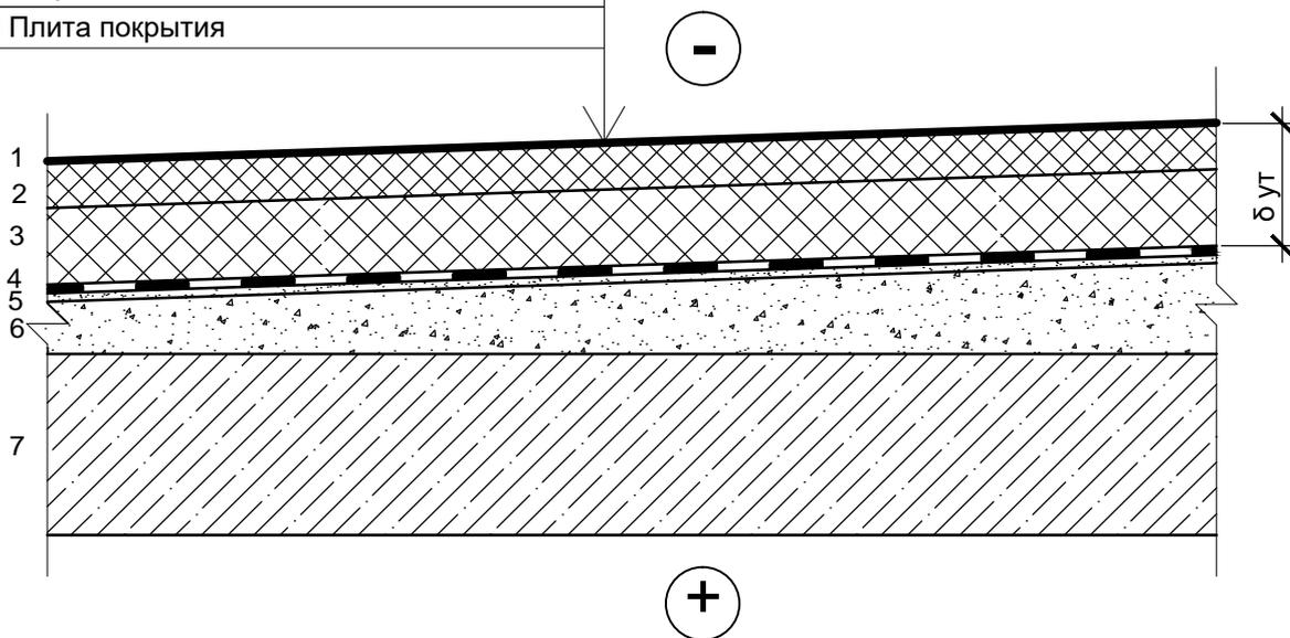
1 Толщина теплоизоляционного слоя принимается по расчёту.
