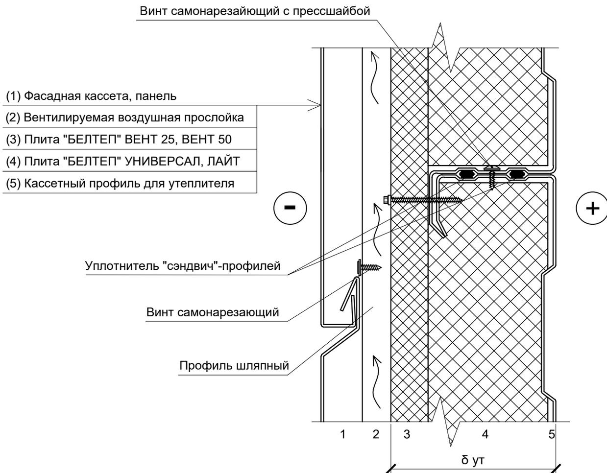
1 Толщина теплоизоляционного слоя принимается по расчету.
