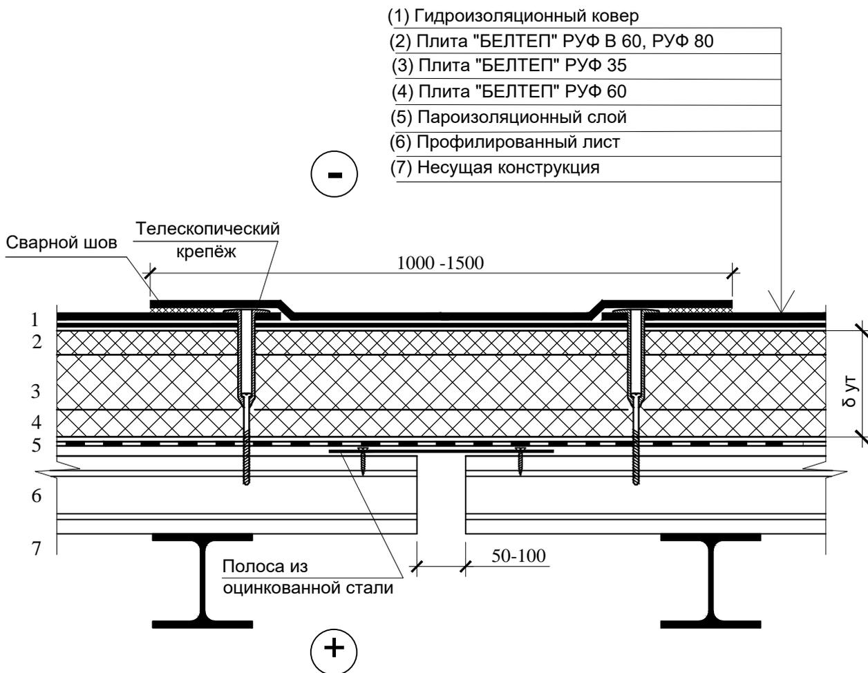
1 Толщина теплоизоляционного слоя принимается по расчету.
