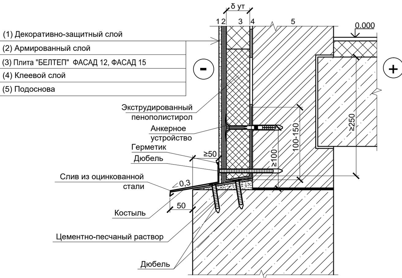
1 Толщина теплоизоляционного слоя принимается по расчету .
