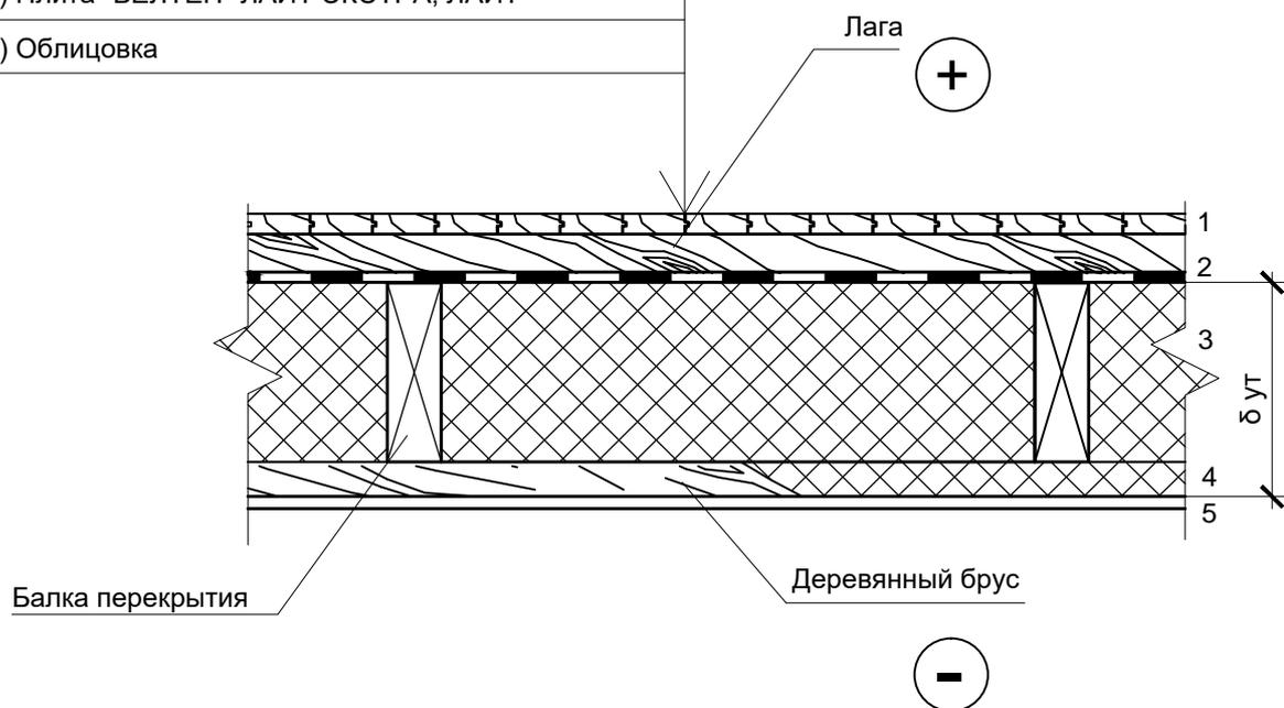
1 Толщина теплоизоляционного слоя принимается по расчету.
