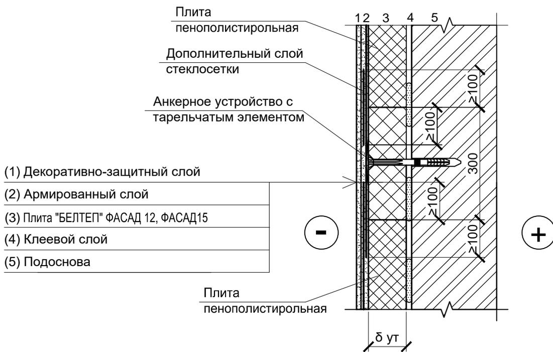
1 Толщина теплоизоляционного слоя принимается по расчету.
